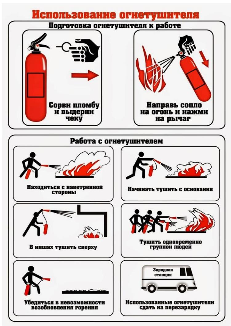
Рис. 8. Инструкция использования огнетушителя
