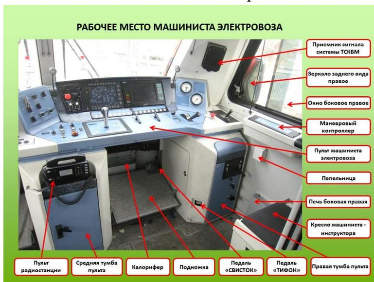
Рис. 23. Схема рабочего места машиниста электровоза
