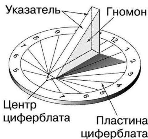
Рис. 28. Схематическое изображение солнечных часов
