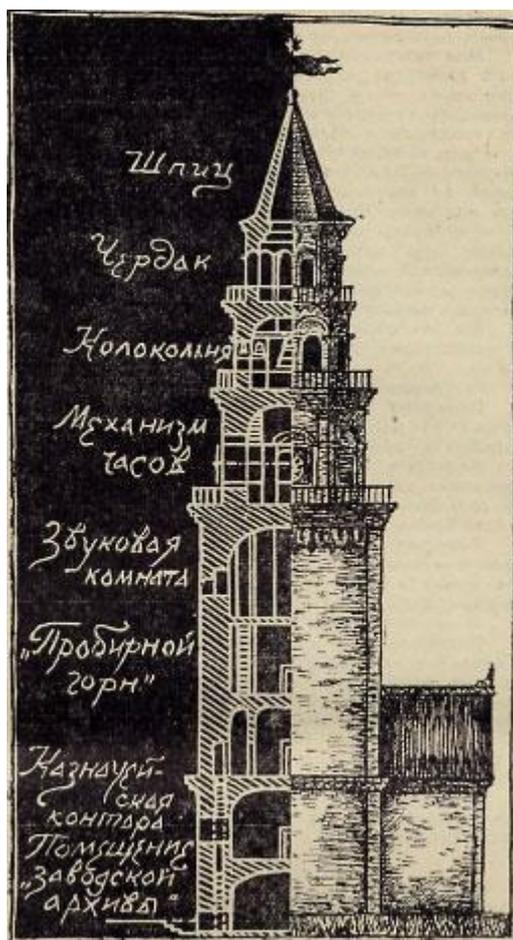
Рис. 5. Наклонная башня Демидовых в разрезе
