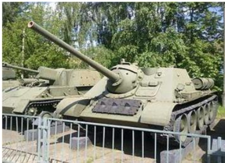
Рис. 11. СУ-85 – средняя по массе советская самоходно-артиллерийская установка (САУ), относящаяся к классу истребителей танков
